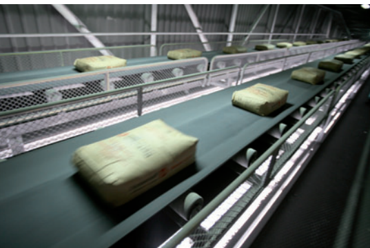
Nowoczesny system transportu cementu workowanego w zakładzie.
