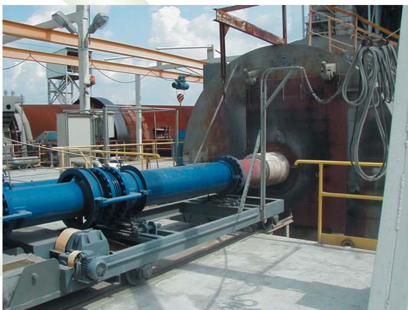
Nowoczesny palnik pieca do wypału klinkieru.
