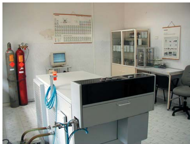
Rentgenowski analizator składu chemicznego w laboratorium cementowni.
