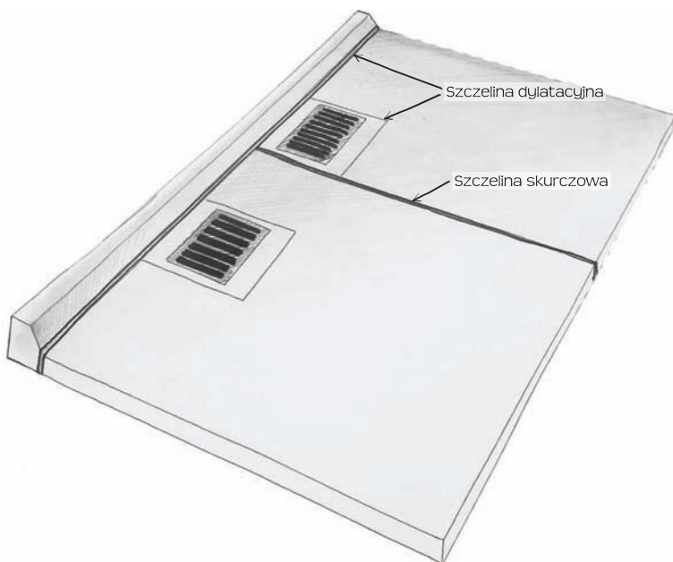
Rys. 6.13. Rozmieszczenie szczelin przy studzienkach
