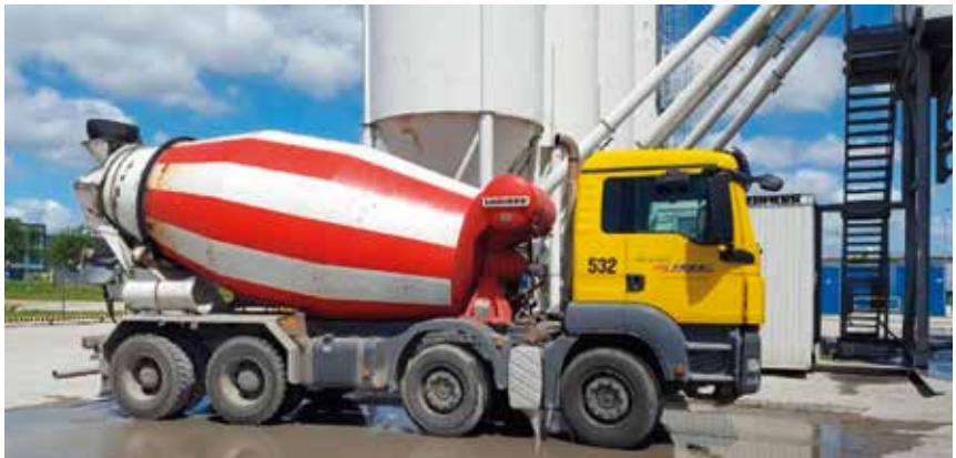
Rys. 3.2. Betonowóz, popularnie zwany gruszką (fot. SPC)
