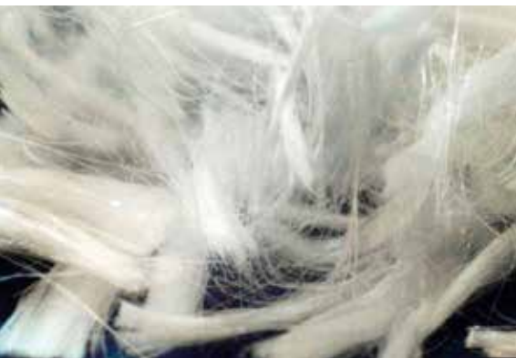
Rys. 2.11. Polimerowe i stalowe włókna stosowane do wzmacniania betonu (fot. ITB)
