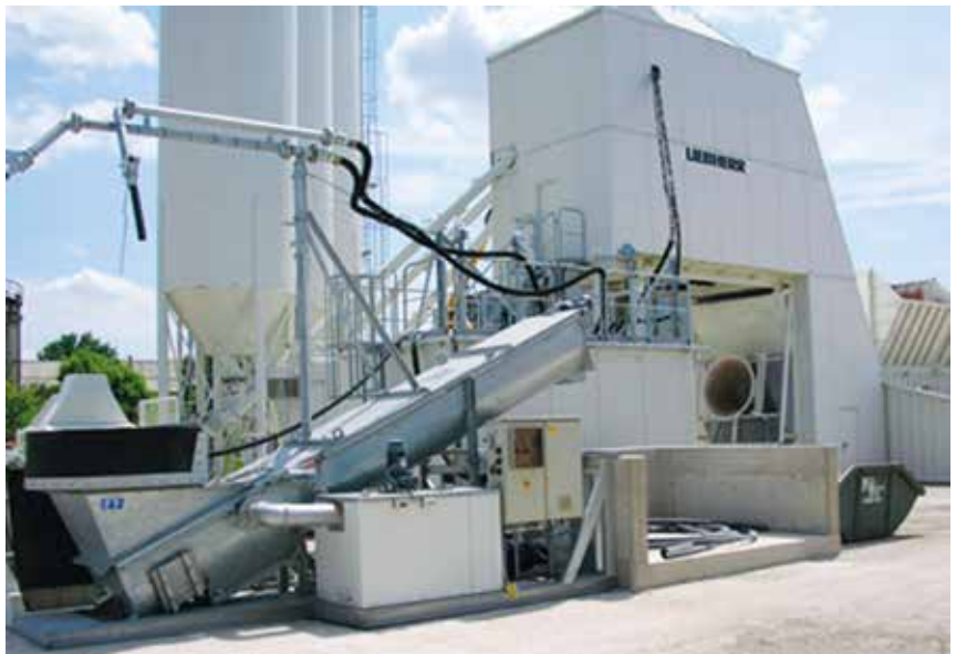
Rys. 13.1. Maszyna (system ślimakowy) do recyklingu betonu o wydajności do 20 m 3 na godzinę [2]
